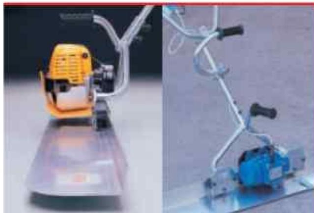
Různé poháněcí jednotky se spalovacím nebo elektrickým motorem
