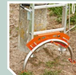
ZARGES Empfehlung für den Einsatz in Verbindung mit Maststeigleitern. Niveaueausgleich bis ca. 210 mm. Integrierte Erdspitzen für sicheren Stand auf gewachsenen Böden.
